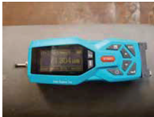
Figura 6. Verifica della preparazione superficiale
